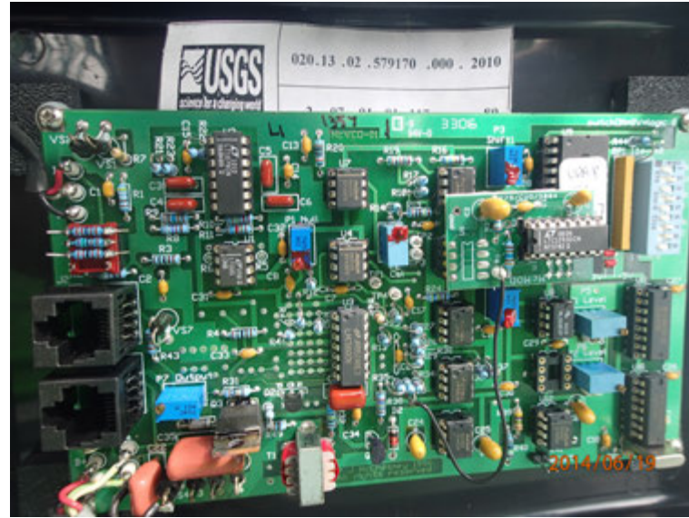
McVCOの基盤. 右上のディップスイッ チにてGainと周波数を設定.
