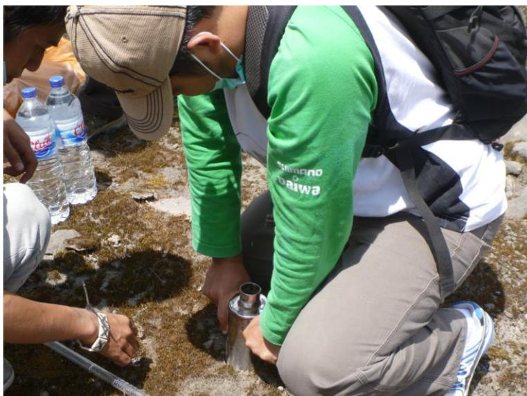
写真-6 浸透能測定機器設置の様子
