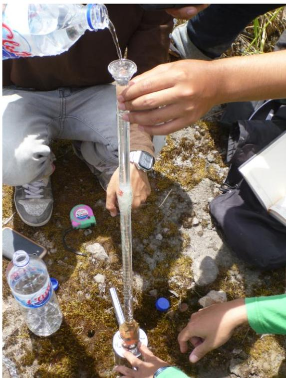
写真-7 浸透能測定の様子
