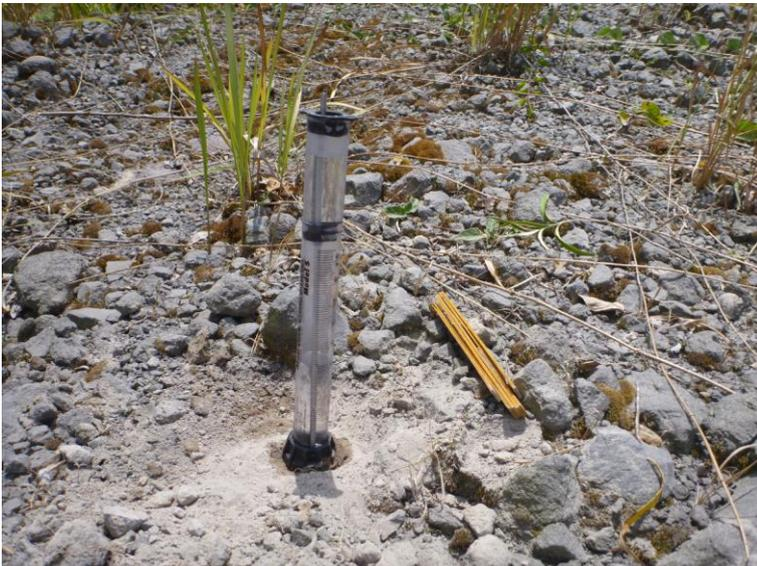
写真-4 Gendol川上流での浸透能試験の様子
